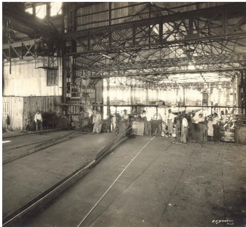
Obreros trabajan en los molinos de laminación para la fabricación de varilla corrugada. Eugenio Espino Barros. N.L., México. N° Inv. 42659 DR. Fototeca Nuevo León - CONARTE, Fondo: Fundidora.
